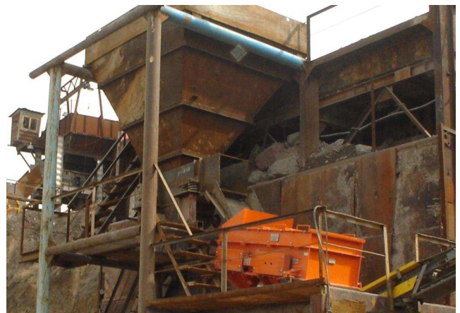
Грохочение гранитного щебня с высокой глинистой составляющей по классу 5 мм
